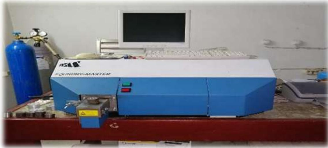
الشكل (3) جهاز التحليل الكيميائي (Foundry-Master)
