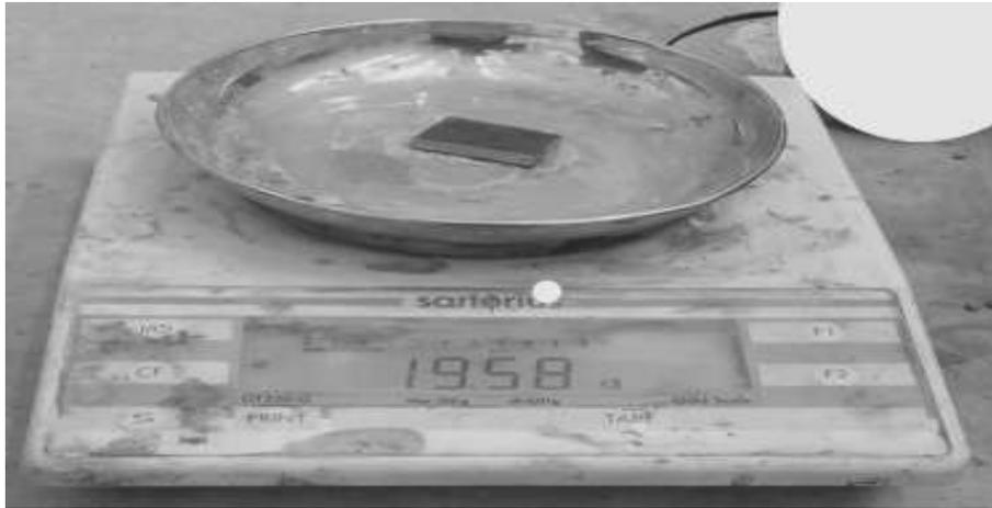
الشكل (2) الميزان المستخدم في وزن عينات سبيكة الحديد (فولاذ أوستينايتي) نوع (321) وبأبعاد  $(2 \times 1)$  Cm
