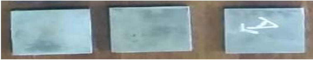
الشكل (1) عينات غير مطلية من سبيكة الحديد (فولاذ أوستينايتي) نوع (321) وبأبعاد  $(2 \times 1)$  Cm
