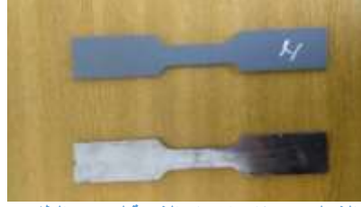
الشكل 2 عينات اختبار الشد قبل وبعد الطلاء
