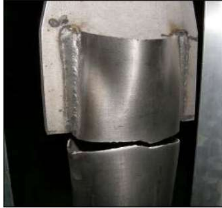
الشكل (4) - تشوهات المقطع CHS المشقوق والملحوم إلى صفيحة تجميع: انهيار بالتمزق خارج منطقة الوصل عند استخدام لحام طولي طويل نسبياً، [11]
