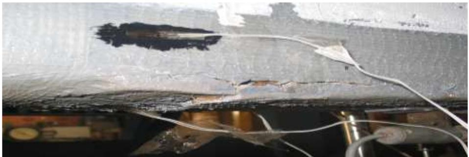
الشكل (11) يبين تمزق صفائح CFRPR
