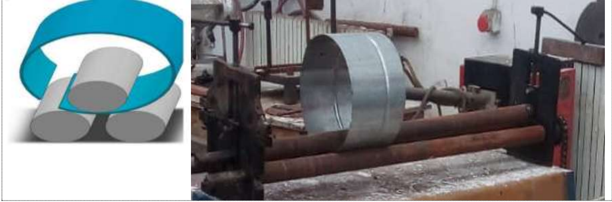
الشكل (1) آلة ثني الألواح التي تم يتم تشغيلها يدويا (نموذج آلة لف بثلاثة أسطوانات)
