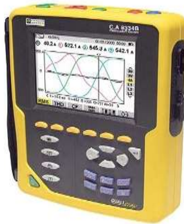
الشكل (16) جهاز محلل الاستطاعة Quali star C.A 8332
