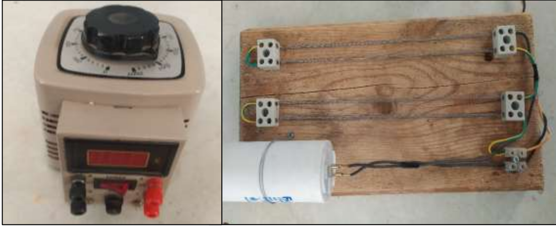
الشكل (12): a- لوحة الاختبار مجهزة بأحمال كهربائية متنوعة. b- محول كهربائي متغير.
