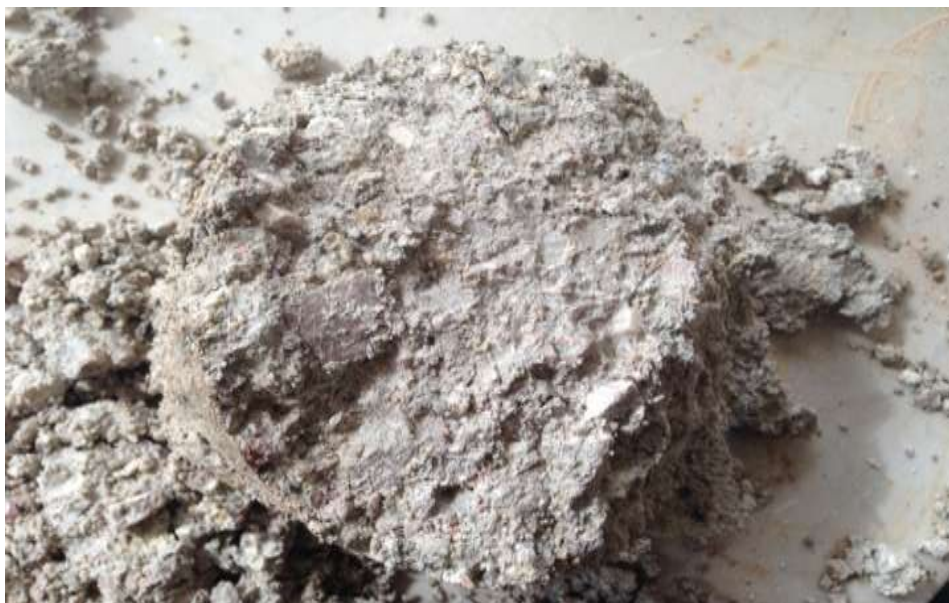
شكل(11): عينة RCA بعد استخراجها من القالب، عقب انتهاء اختبار CBR
