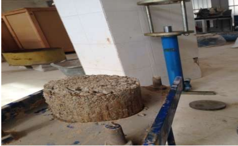
شكل (10): عينة RCA اخراجها من القالب بعد اختبار CBR
