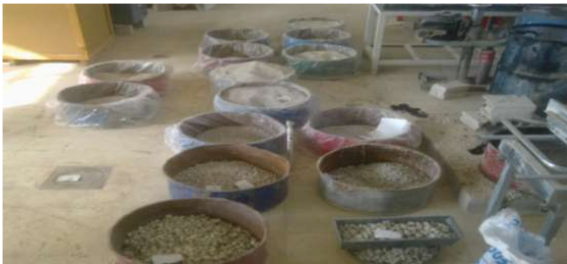
الشكل (5): الحصىات البيتونية المدورة (RCA) بعد فرزها حجماً في المخبر
