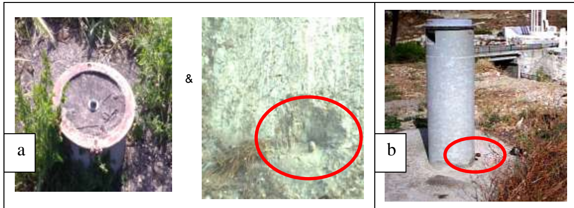
الشكل (3) بعض أشكال النقاط المرجعية المستخدمة في مراقبة السدود
