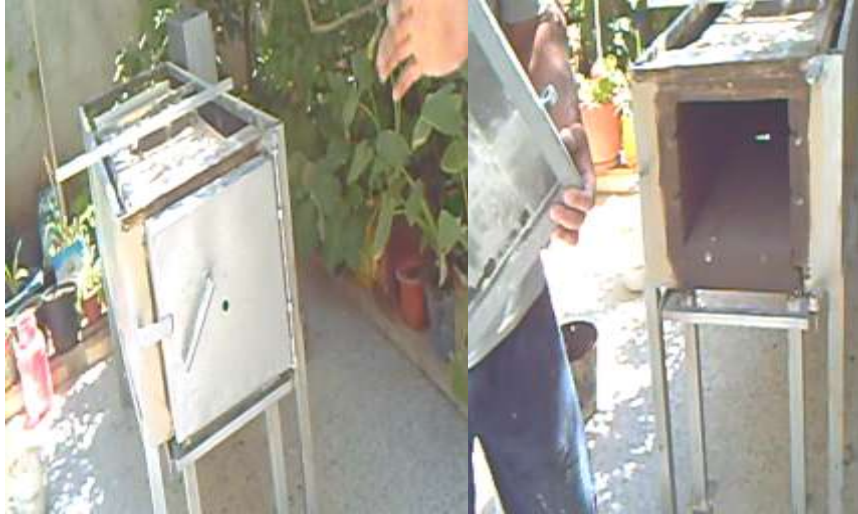
شكل (2-2) الفرن الكهربائي المستخدم لحرق العينات البيتونية [2]
