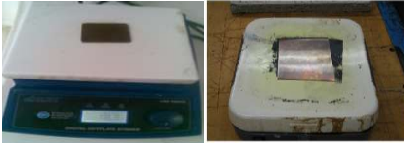
الشكل (1) عملية تسخين الصفائح النحاسية وتشكل أكسيد النحاسي
