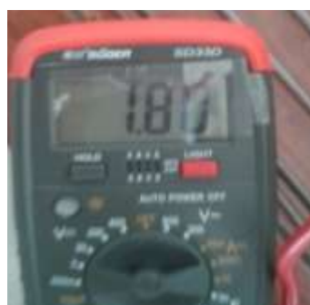
الشكل (30) قيم تيار وتوتر خرج المقطع عند إشعاع G=680\text{[W/m}^2] .
