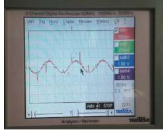
الشكل (24) خرج دائرة المقطع عندما V > V_{MPP} .
