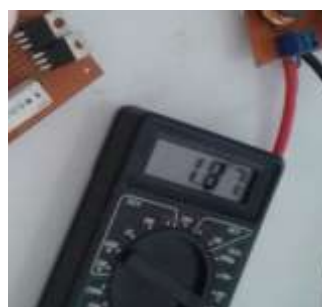
الشكل (31) قيم تيار وتوتر خرج المقطع عند إشعاع G=900\text{w/m}^2 .
