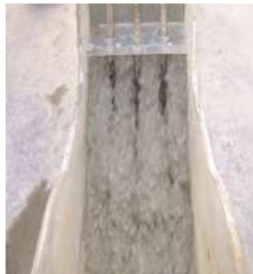
الشكل (5-2): يبين شكل الصندوق L- لحظة رفع الحاجز ومرور الببتون
