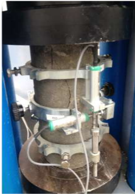
الشكل (3-1): اختبار عينة أسطوانية على الضغط المحوري
