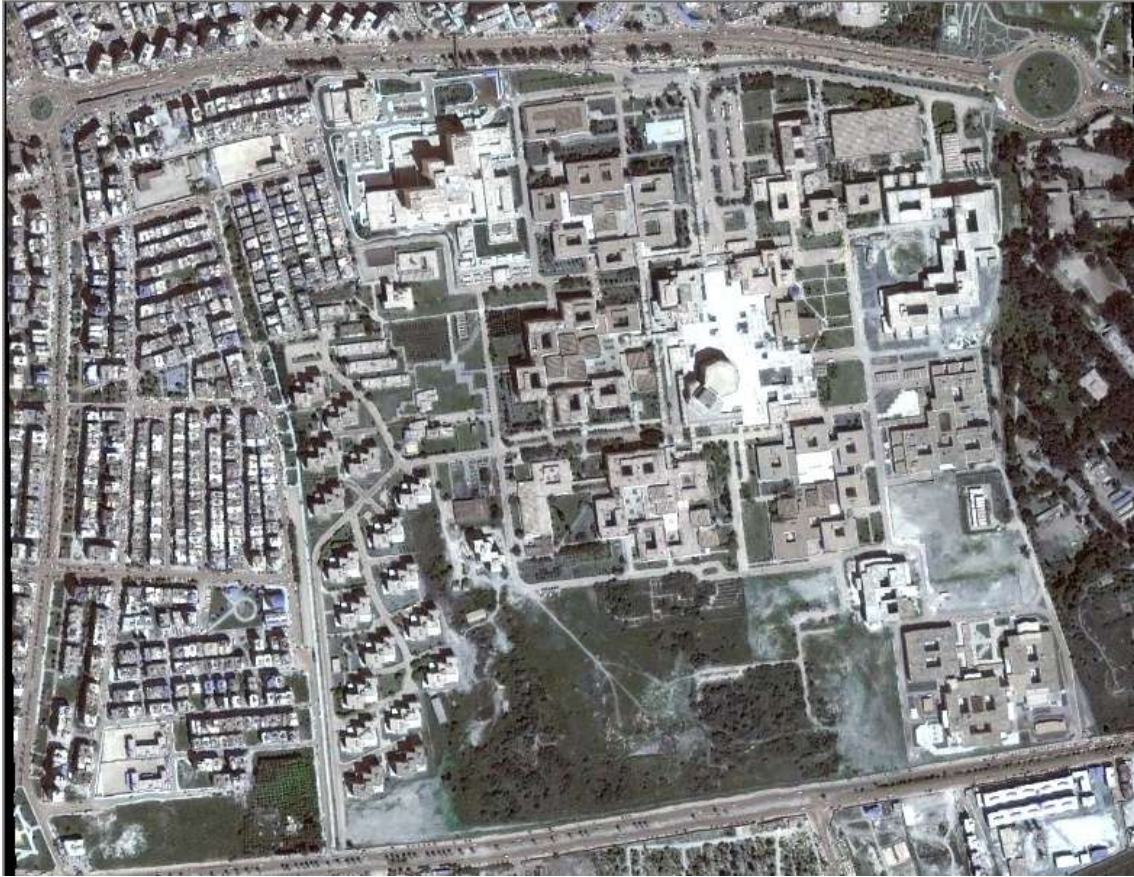
الشكل (8). الصور المصححة عمودياً (الأورتوفوتو) لمنطقة تداخل الصورتين.
