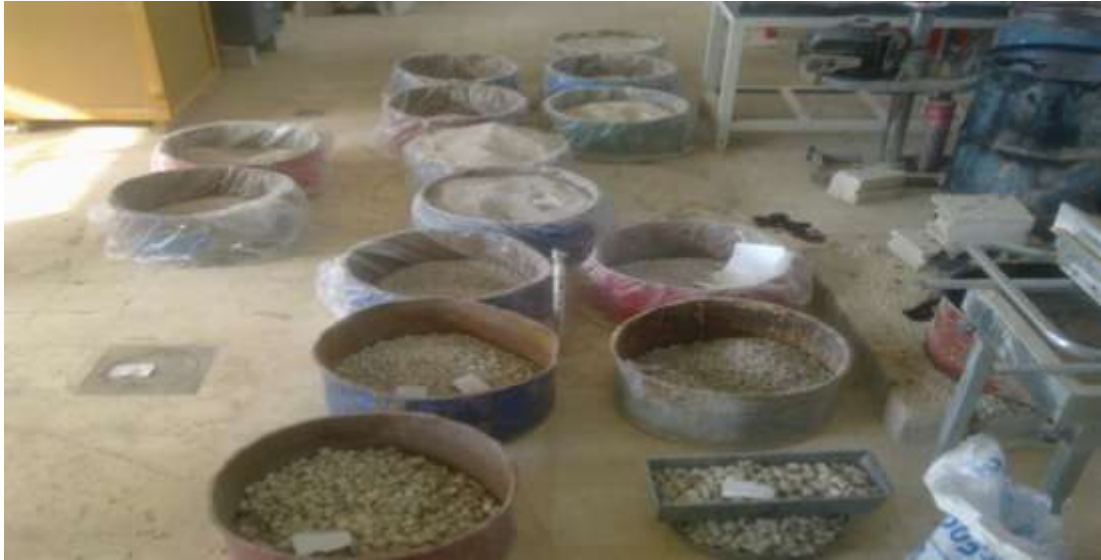
الشكل (3): الحصىات البيتونية الم عاد تدويرها (RCA) بعد فرزها حجماً في المخبر
