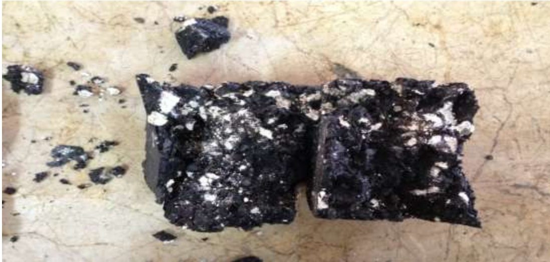
الشكل(7) عينة قالب مارشال بعد الكسر ، خلطة RCA100
