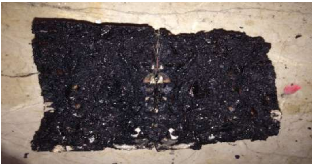
الشكل(8) عينة قالب مارشال بعد الكسر، خلطة NA
