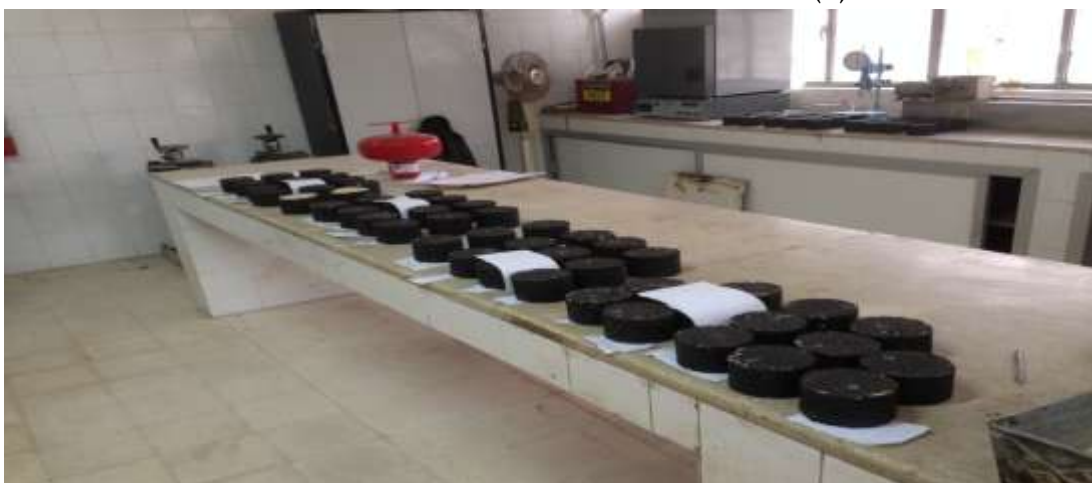
الشكل (5) صورة لمجموعة قوالب مارشال تم تحضيرها للاختبار
