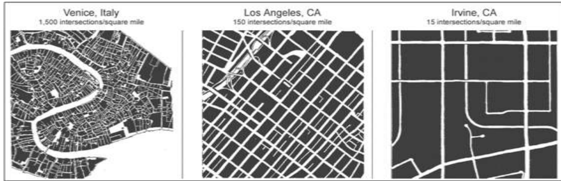
الشكل (5) مقارنة بين عدد التقاطعات في الشبكة لثلاث مدن ضمن مساحة ميل 2 تفوق عدد التقاطعات في شبكة مدينة Venice 100 مرة عن التقاطعات في مدينة Irvine [9]
