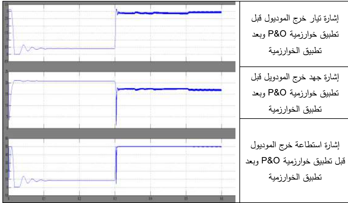
الشكل (19) يبين إشارات التيار والجهد والاستطاعة
