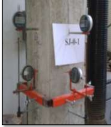
الشكل (3) توضع مقياس الانتقال الطولية والجانبية للعينة SJ-0-1
