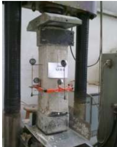
الشكل (7) تجربة التحميل على العينة SJ-0-1
