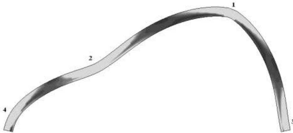
الشكل (13): التشوهات النسبية الرئيسية (Principal strain) للقوس بعد التقوية وتسلسل تشكّل مفاصل ميكانيكية الانهيار.
