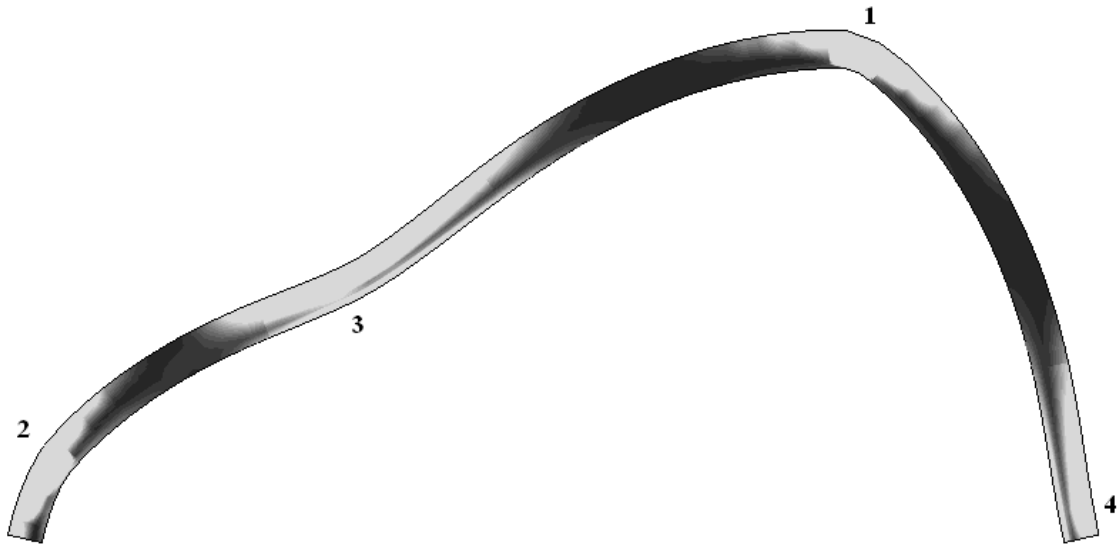
الشكل (16) : التشوهات النسبية الرئيسية للقوس بعد التقوية وتسلسل تشكل مفاصل ميكانيكية الانهيار لحالة السماكة 1.3mm
