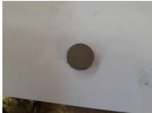
الشكل (6): صور للمدمج الأخضر الأسطواني الناتج
