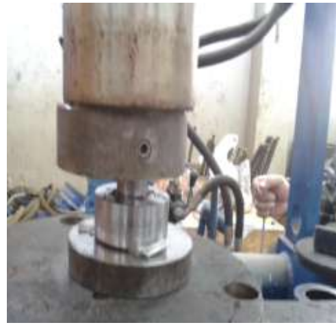
الشكل (4): القالب أثناء القيام بعملية التدميج
