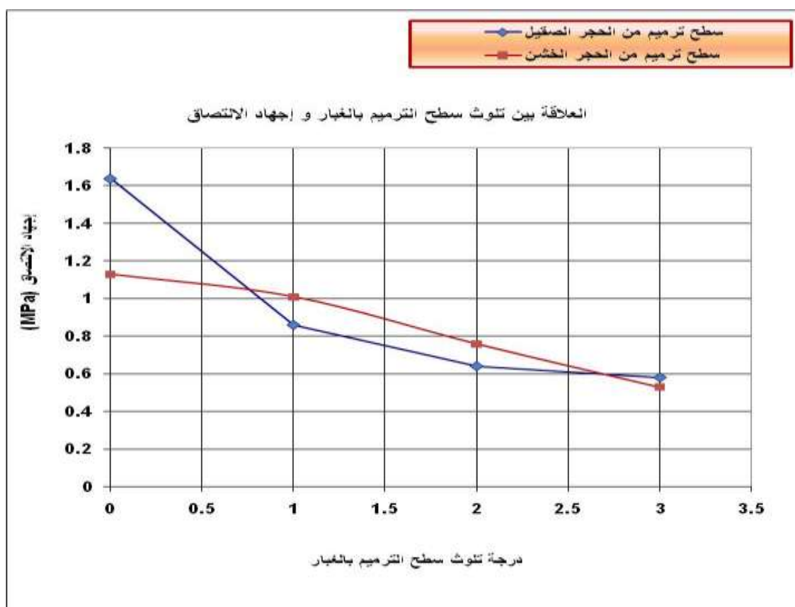
الشكل 9: تأثير درجة تلوث سطح الترميم من الحجر الصقيل و الخشن على إجهاد الالتصاق
