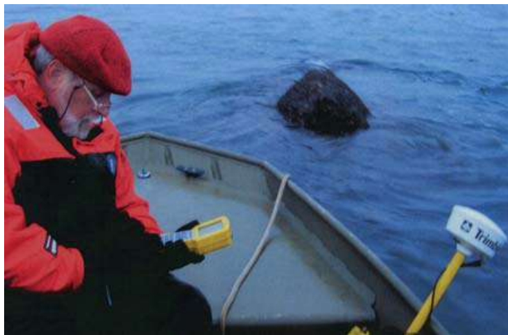
الشكل 6 استخدام تقنيات GPS لتحديد مواقع أدق التفاصيل أو الجزر من أجل رسم خط الأساس [7]
