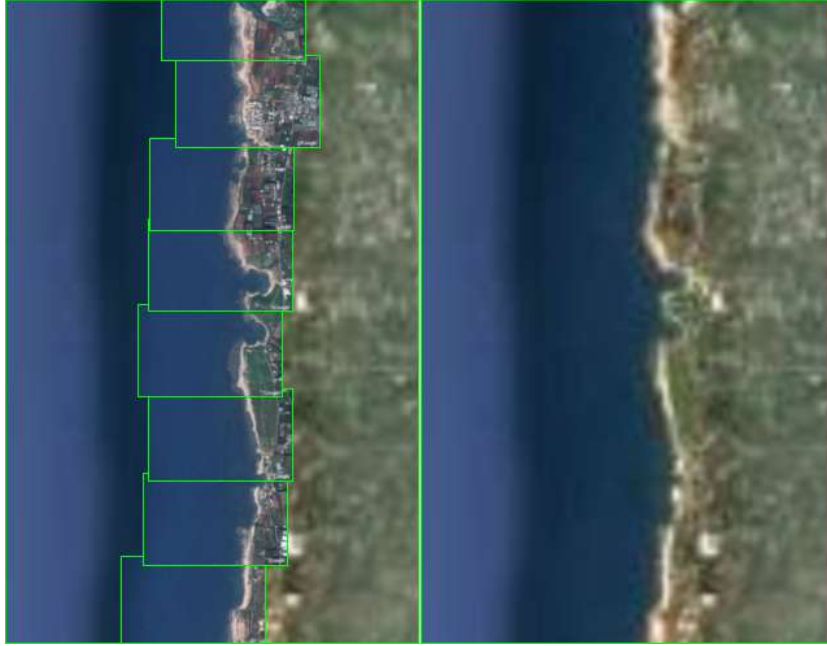
الشكل 9 جزء من الصورة الشاملة إلى اليمين وعملية تركيب الصور التفصيلية عليها إلى اليسار رسم خط الساحل على الصور التفصيلية أو رقمته خط الساحل بواسطة أمر Polyline في برنامج
