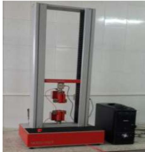
الشكل (5) جهاز اختبار الشد
