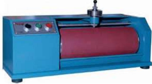
الشكل (10) جهاز قياس مقاومة الاحتكاك
