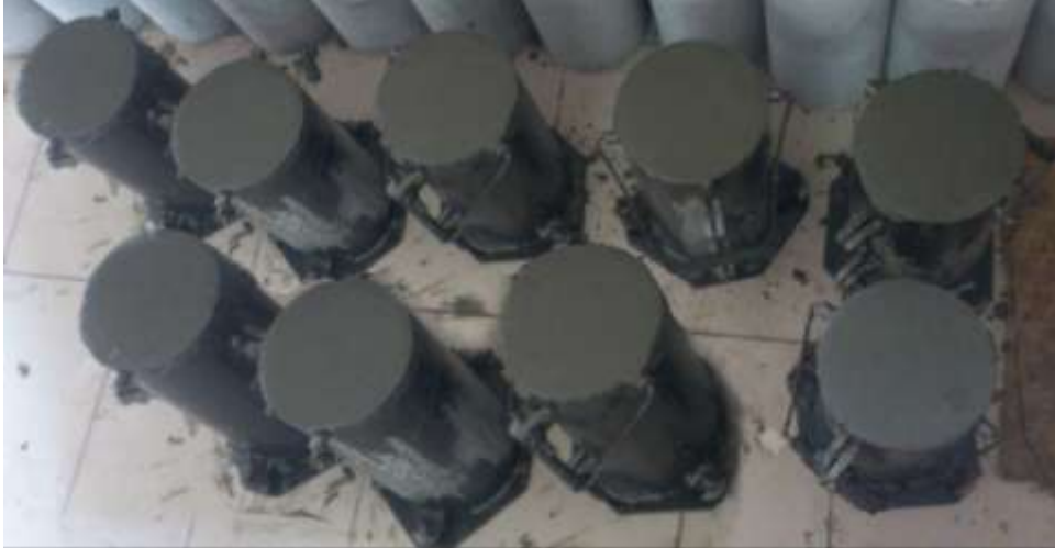
الشكل (5) يوضح العينات الاسطوانية المصبوبة
