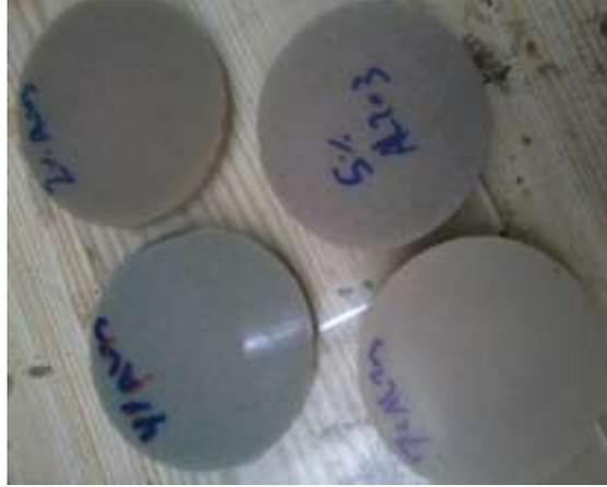
الشكل (5) - عينات الاختبار بعد تمام التصلب.
