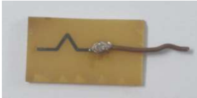
الشكل (17) الهوائي عند درجة التجزيء الأولى
