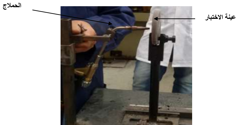
الشكل(3) - طريقة تثبيت العينات في الجهاز
