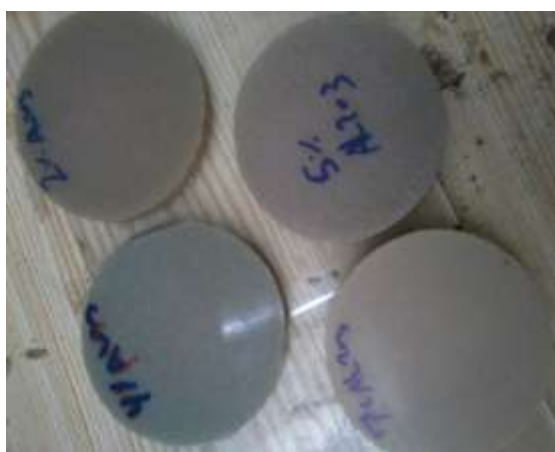
الشكل (5) - عينات الاختبار بعد تمام التصلب.
