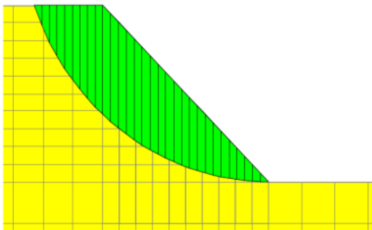
الشكل (4) الكتلة المنزلقة على سطح الانهيار مقسمة إلى شرائح فوق شبكة العناصر المنتهية.
