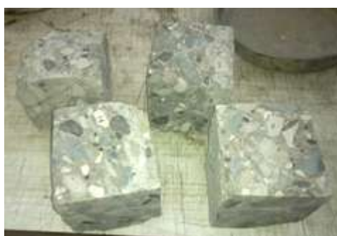
الشكل (4): العينات المكعبة البيتونية من العناصر الإنشائية للمبنى المهدم
