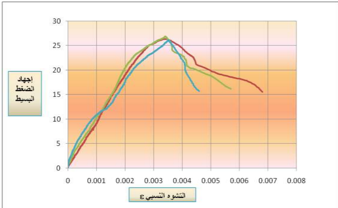
الشكل (14): منحنى السلوك (الإجهاد التشوه) لثلاث عينات منالخطة RAC75
