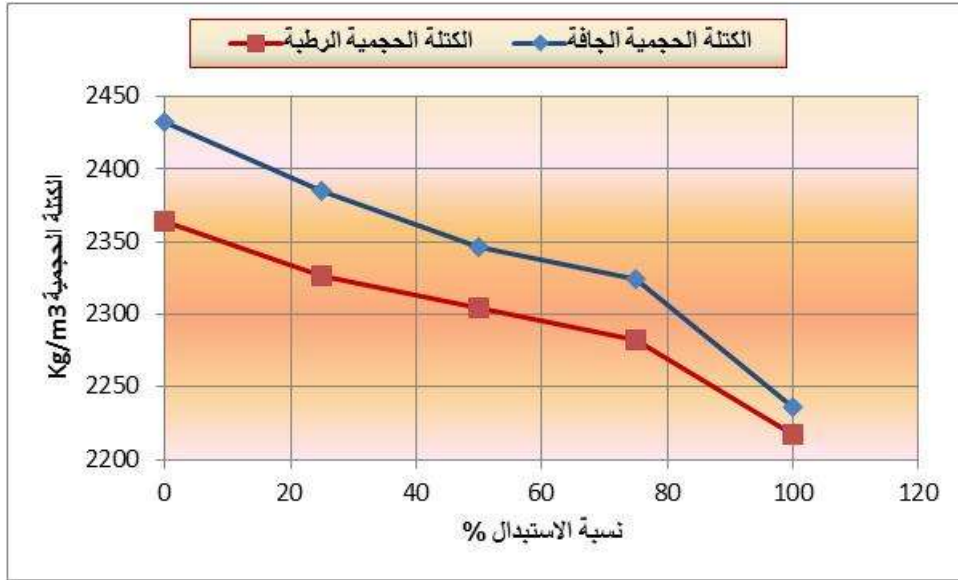
الشكل (8): الكتلة الحجمية الرطبة و الجافة كتابع لنسبة الاستبدال
