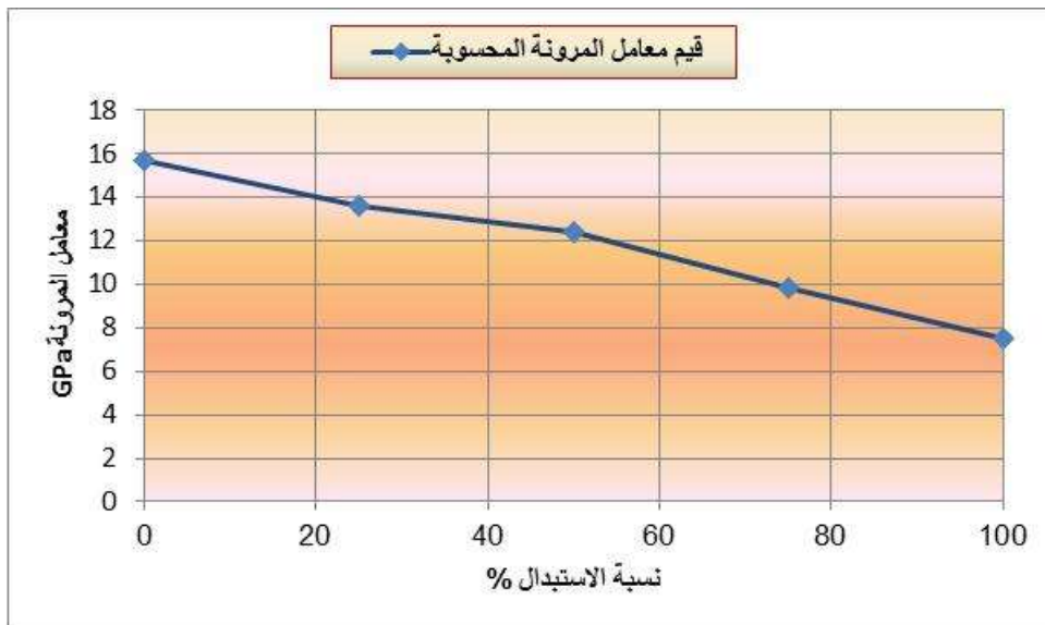
الشكل (16): تغير قيم معامل المرونة بدلالة نسب الاستبدال
