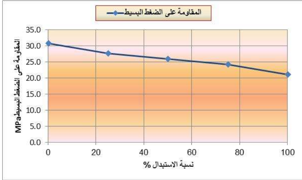
الشكل (10): متوسط قيم المقاومة الأعظمية على الضغط البسيط بحسب نسب الاستبدال
