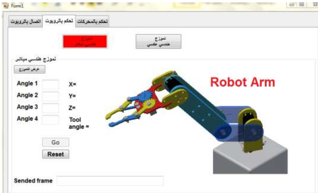
الشكل (14): واجهة التحكم بالذراع الروبوتي (النموذج الهندسي المباشر والعكسي).
