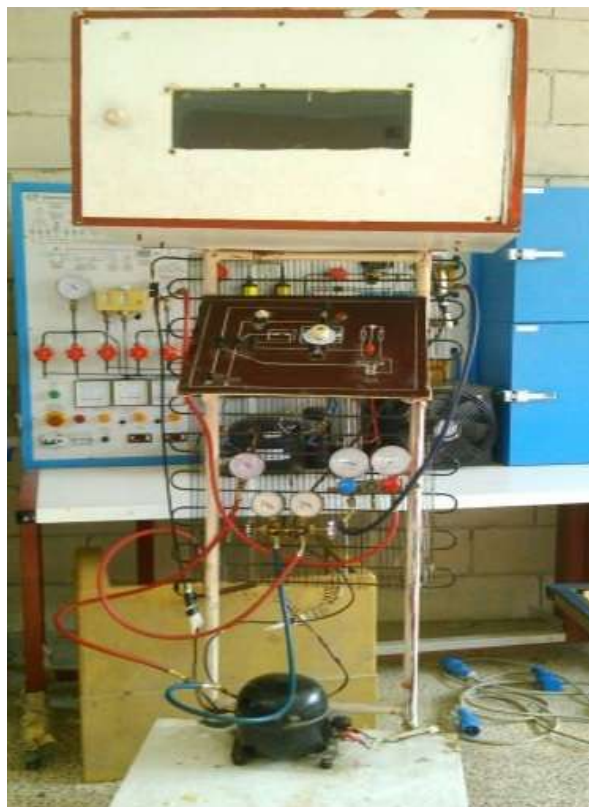
الشكل (1) دائرة التبريد المستخدمة في التجريب
