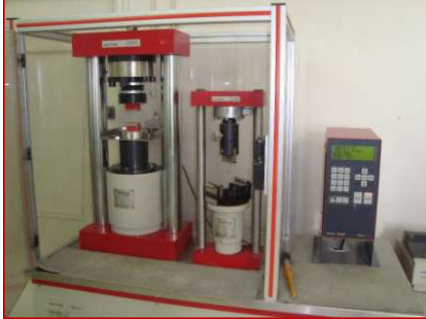
الشكل رقم (3) صورة تظهر آلة اختبار الضغط و الانعطاف لمواشير الملاطات الإسمنتية المدروسة
