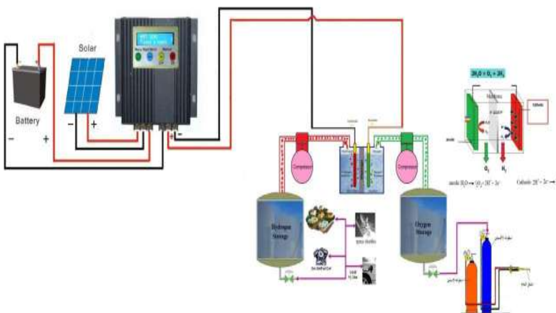
الشكل (1) مخطط النظام الكهروضوئي-محللة المستخدم في عملية إنتاج الهيدروجين .
