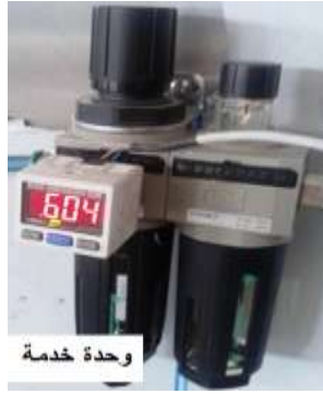
الشكل (6): وحدة خدمة هوائية مع مؤشر ضغط رقمي.
