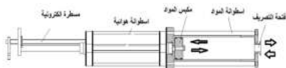
الشكل (3): مقطع طولي في المجموعة الأولى لمنصة الاختبار.
