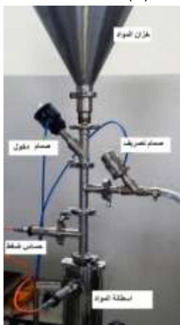
الشكل (4): القسم العلوي من المجموعة الأولى لمنصة الاختبار.
