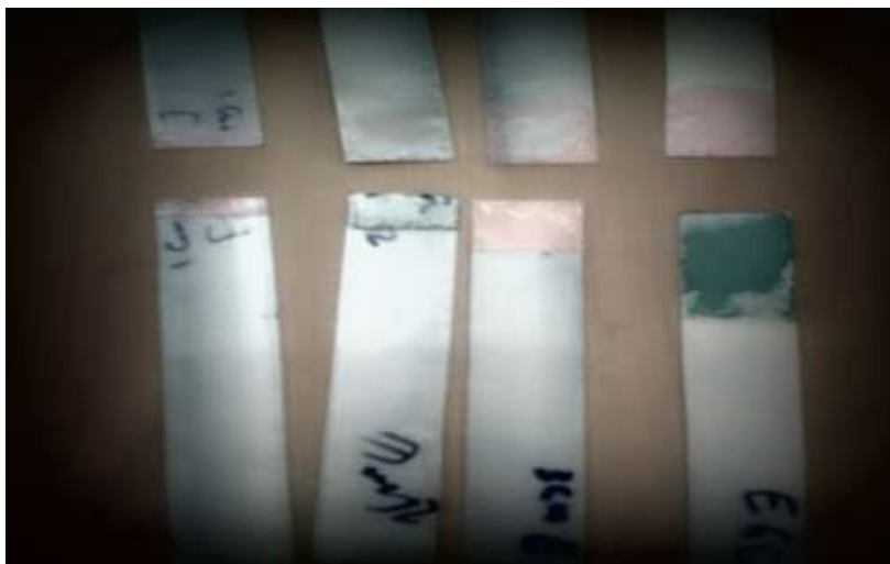
شكل(5) الوصلات الملتصقة بالايبيوكسي بعد اختبار الشد
