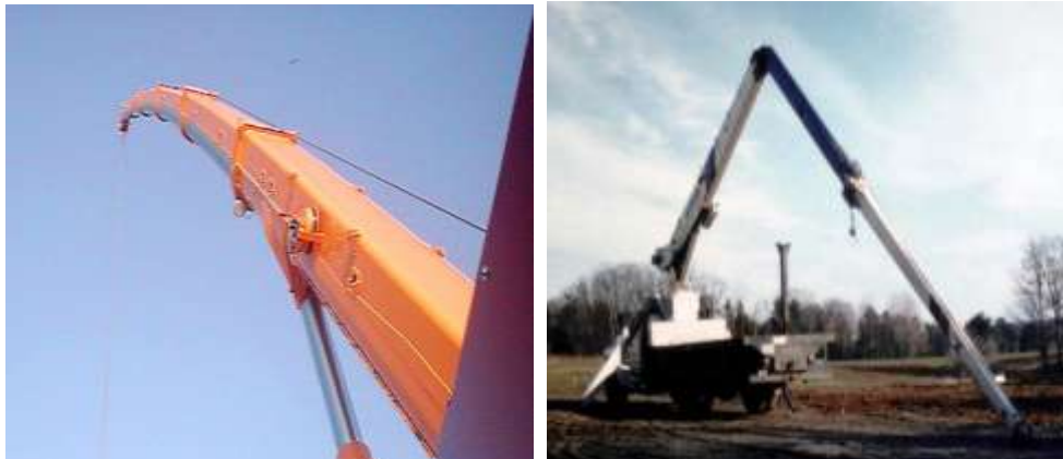
الشكل (3) حالة الانحناء /التحنيب/ وحالة الانهياب للسهم التلسكوبي.
