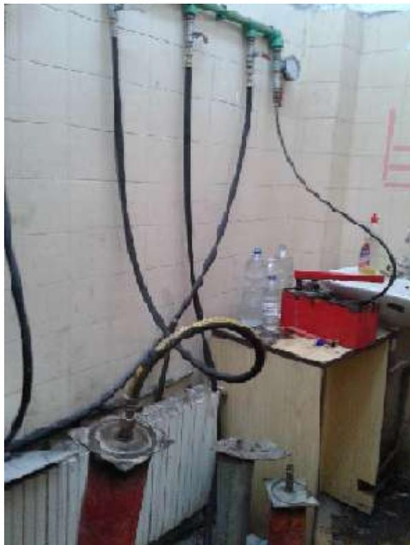
الشكل (3) عينة اختبار موصولة مع جهاز قياس الضغط.
