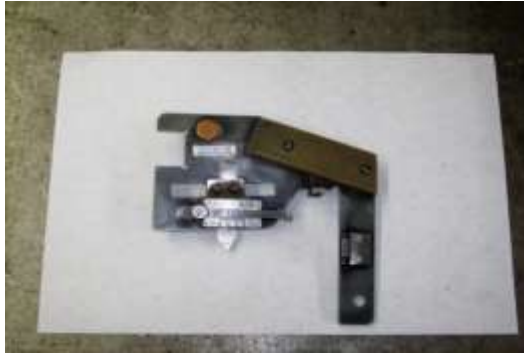
الشكل (4) : أ-جهاز الشابلون لقياس تآكل العجلات. ب- جهاز السوكبا لقياس تآكل الخط.
