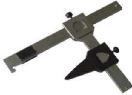
الشكل (4) : أ-جهاز الشابلون لقياس تآكل العجلات. ب- جهاز السوكبا لقياس تآكل الخط.
