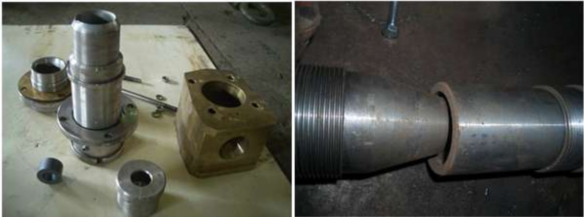
الشكل (5) a- يظهر مكونات علب التيرمكس. b- يظهر القطع المتداخلة ضمن علب التيرمكس.
