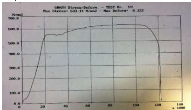
الشكل (20) يمثل المنحنى البياني لعملية الشد للقضبان المنتجة باستخدام التيرمكس من البيليت من الدرجة 4ps
