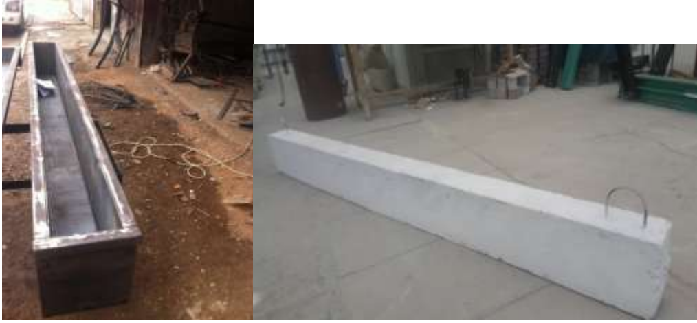
الشكل (7) القالب المعدني المستخدم لصب الجوائز
