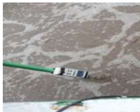
الشكل (4): جهاز قياس تركيز الأوكسجين المنحل والمسبر في الحوض على عمق (4m).
