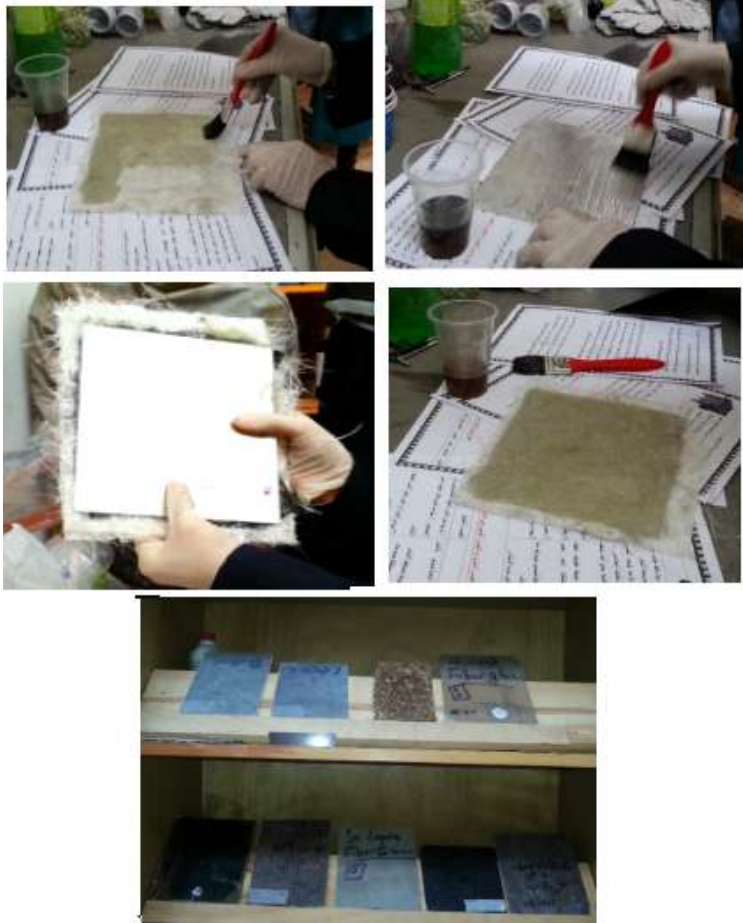
الشكل (2) عملية تحضير عينة البولي استر المسلح بالألياف الزجاج وفق طريقة Lay-up.
