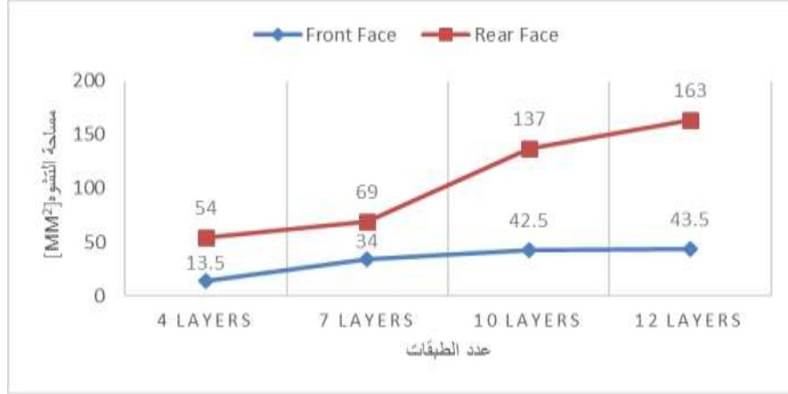
الشكل (5) منحنى تغير مساحة التشوه في الوجهين الأمامي والخلفي لعينات البولي استر المسلح بألياف الزجاج المنسوج.
