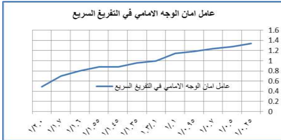
الشكل (9) تغير عامل الأمان بالنسبة لتغير سماكة النواة عند التفريغ السريع للوجه الأمامي
