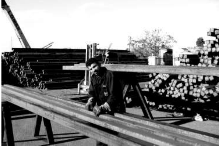
الشكل ( 6 ) - التحضيرات الأولية للبيليت قبل إجراء الفحص بالأمواج فوق الصوتية
