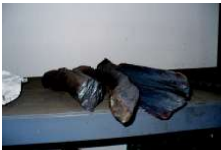
الشكل (4) - بعض المتضمنات اللامعدنية التي وجدت ضمن بيليت حديد التسليح وسببت إيقاف خطوط الإنتاج عن العمل
