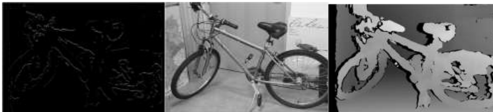
الشكل (18) المشهد الأيسر و خريطة التفاوت باستخدام SGM من أجل الزوج المجسم bicycle قبل الضغط ،
