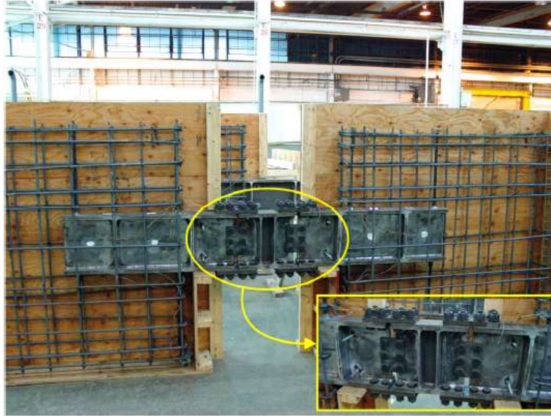
الشكل (1) تصميم الفاصمة القابلة للاستبدال ضمن الجيزان المعدنية المقترنة في بحث Fortney [5].
