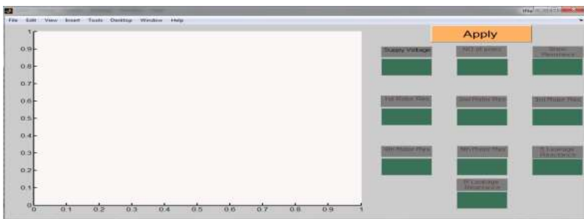
الشكل(2-ج): الواجهة المصممة باستخدام برنامج MATLAB لدراسة أثر إضافة مقاومات إلى مقاومة الجزء الدوار للمحرك الحثي.
