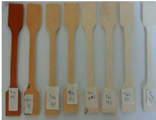
الشكل (9) عينات اختبار الشد [ PU+(0-35% \text{TiO}_2 ) ]
