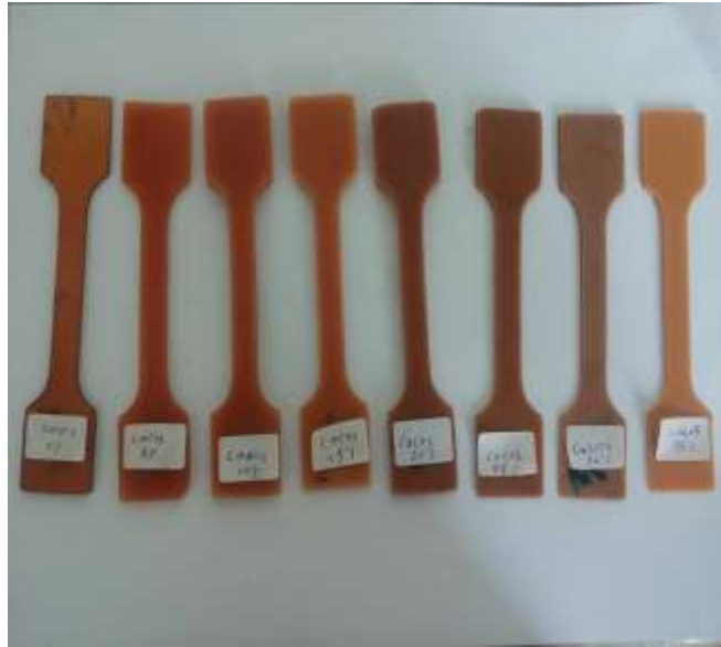
الشكل (8) عينات اختبار الشد [ PU+(0-35% \text{CaCO}_3 ) ]
