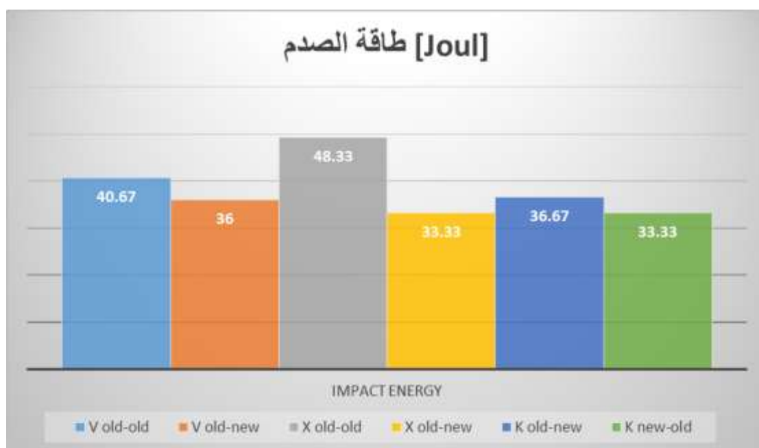
الشكل (13) مخطط تغير طاقة الصدم حسب نوع الوصلة للحامية
