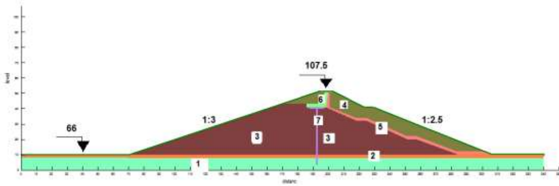
الشكل (5) يبين مقطعاً عرضياً للسد بعد التأهيل و مواصفات طبقات التربة المشكلة له [1]
