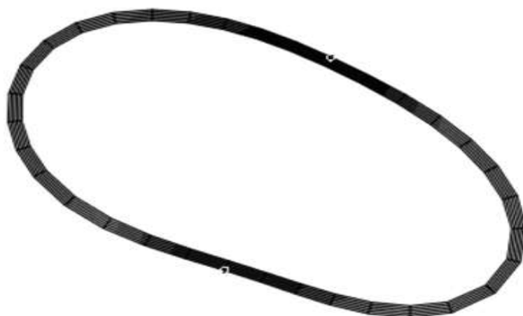
الشكل (10): الشكل المتشوّه للنفق المدروس (الدراسة الحالية)
